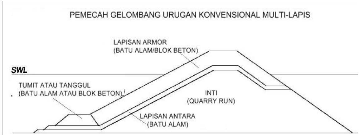
Gambar II.F.25 Pemecah gelombang urugan multi-lapis konvensional
